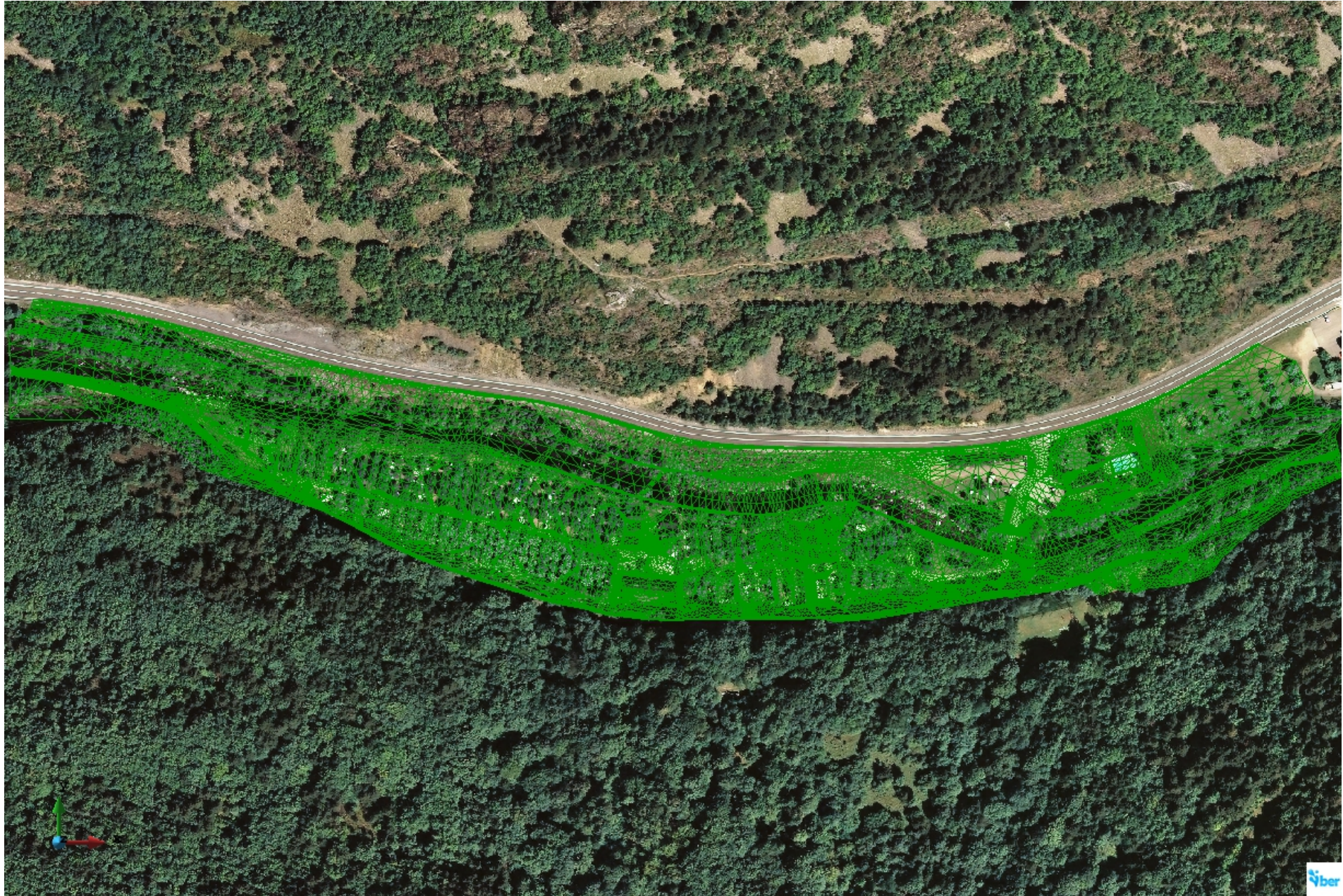
Malla de cálculo para la discretización bidimensional de la zona de estudio en situación original.
